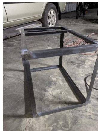
Gambar 7. Rangka Penggoreng Deep Fryer
