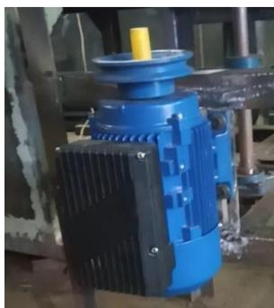
Gambar 9. Motor Induksi 1 Fasa
