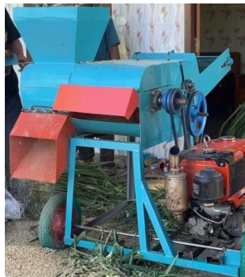
Gambar 4. Mesin Pencacah Pakan Kapasitas 200 Kg/Jam.
