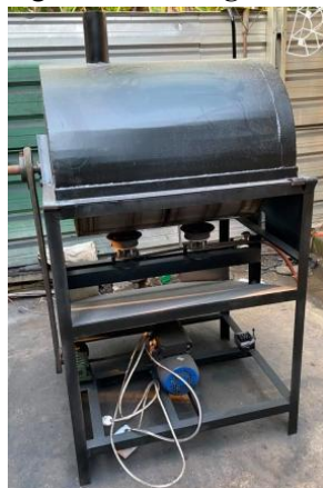
Gambar 2. Mesin Roasting Biji Kopi Kapasitas 50 Kg/Jam
