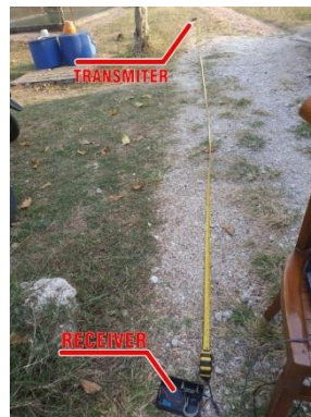
Gambar 13. Pengukuran Jarak Transmisi Pengiriman Data Antara Transmitter Dan Receiver
