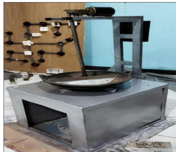
Gambar 6. Alat penyangrai biji kopi otomatis berbasis arduino uno
