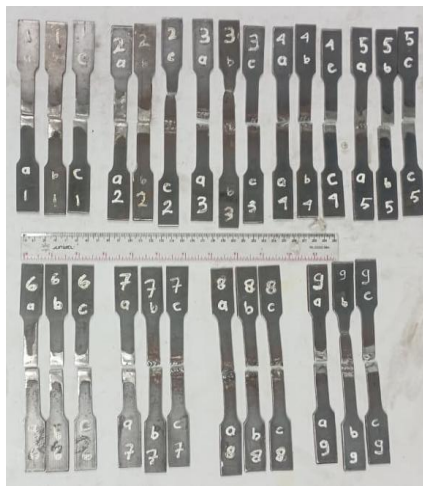
Gambar 2. Spesimen setelah uji tarik
