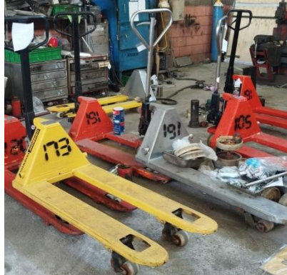
Gambar 3. Alat Hand pallet Kapasitas 3 ton
