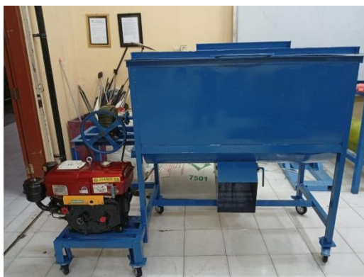
Gambar 4 Mesin pengaduk kompos kapasitas 200 kg/jam
