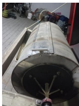
Gambar 5. Tabung pengering hasil fabrikasi
