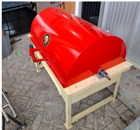
Gambar 1. Mesin Grain Dryer Serbaguna Tipe Rotary Kapasitas 50 kg
