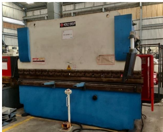
Gambar 1. Mesin Press Brake Hidrolik dan Spesimen Uji
