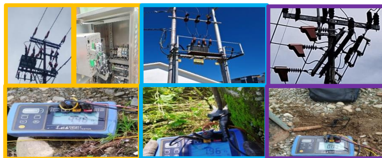
Gambar 3. Documentasi Pengukuran Lbs, Trafo, dan Fco Sutm
