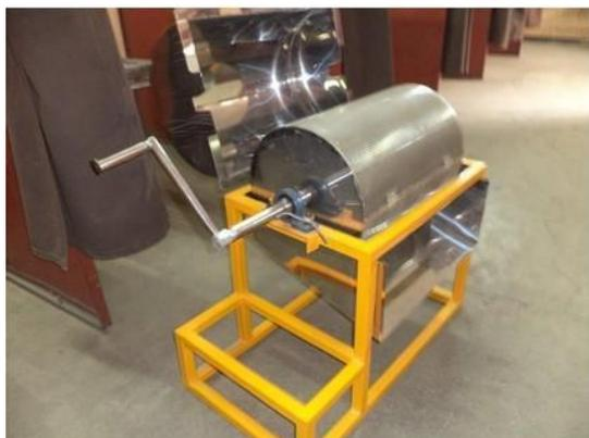
Gambar 3. Mesin Cuci bengkuang dengan sistem silinder berputar [6]
