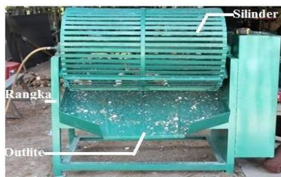
Gambar 1. Mesin Pengupas Dan Pencuci Singkong Tipe Horizontal [4]
