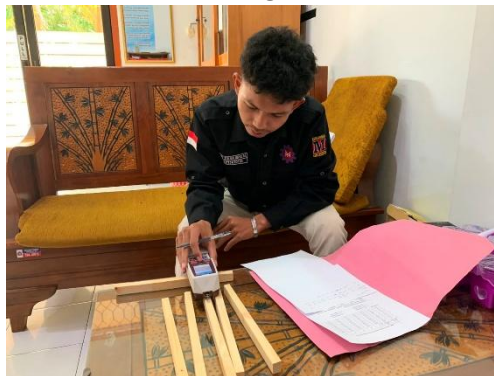
Gambar 6. Pengujian Kekasaran Permukaan Menggunakan Surface Rouhness Taster
