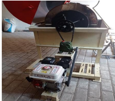
Gambar 4. Hasil Perancangan Mesin Grain Dryer Serbaguna Tipe Rotary Berkapasitas 50 kg
