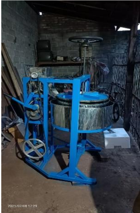
Gambar 11. Mesin pamarut kelapa dan peras santan kapasitas 10 kg
