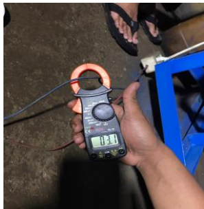
Gambar 6. Hasil pengukuran arus menggunakan ac clamp meter tanpa beban pamarutan
