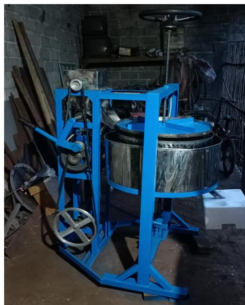
Gambar 5. Mesin pamarut dan pemeras kelapa bersistem hidrolik
