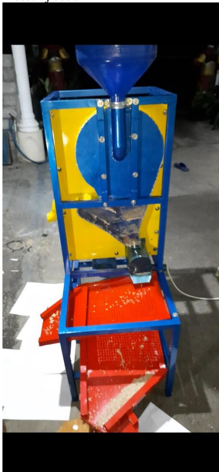
Gambar 13. Uji coba mesin pengolah gabah kapasitas 5kg
