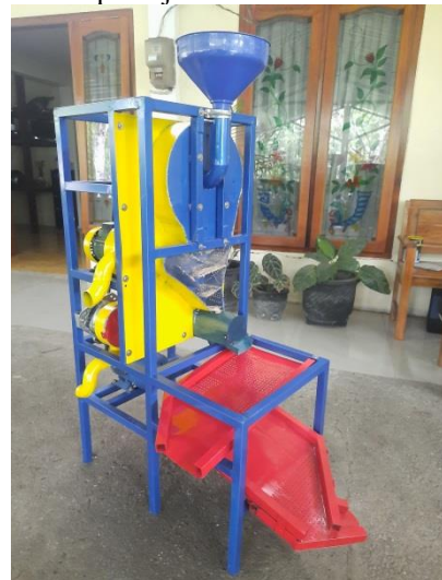
Gambar 12. Mesin pengolah gabah kapasitas 5kg
